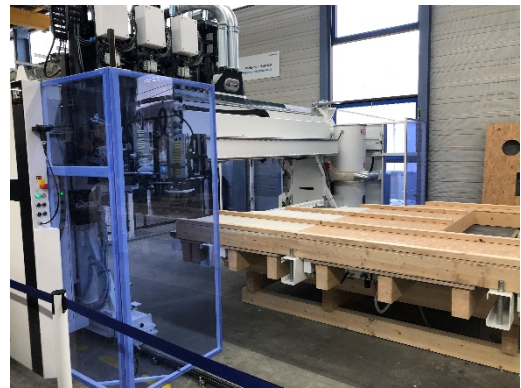
Centre d'usinage de découpe de murs et clouages de pièces
