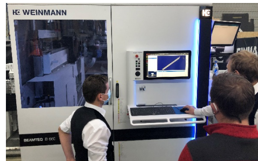
Machine de découpe et d'usinage d'assemblage sur des barres de 12m de long
