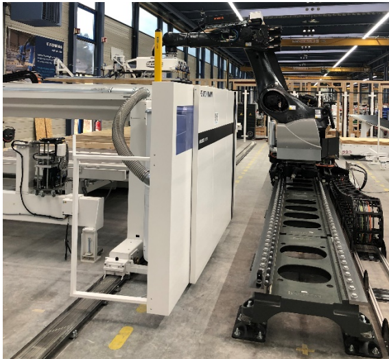
Robot poseur de plaques d'OSB sur des murs assemblés
