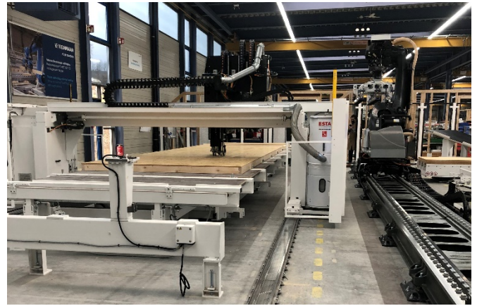
Portique de fixation des plaques d'OSB sur les murs
